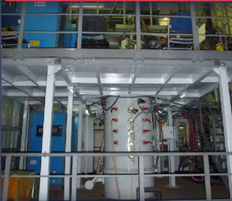
Общий вид установки с холодным тиглем для выращивания слитка мультикремния 350x350 мм<sup>2</sup>, **длина** непрерывно выращивающегося слитка **до 12 м**
